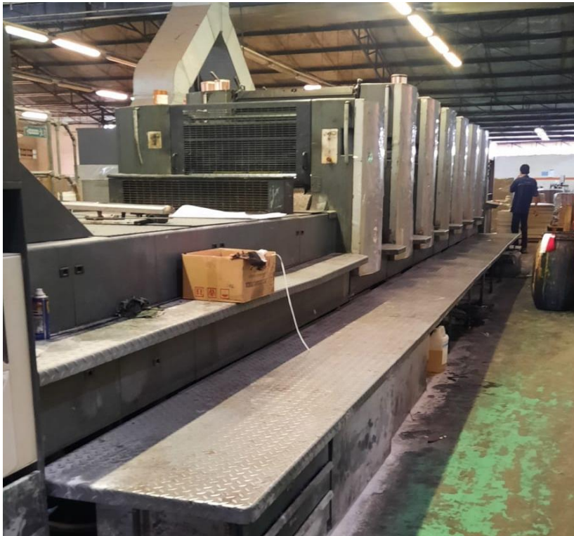
Gambar 9. Mesin offset speedmaster 102 Sumber: Dokumentasi pribadi
