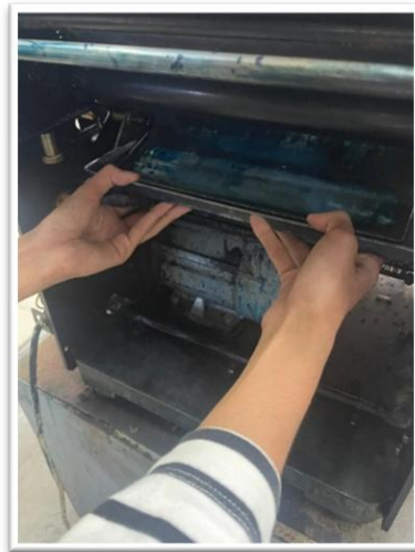
Gambar 13. Pemasangan Sistem Pembasah
