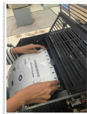
Gambar 17. Pemasangan Pelat Logam
