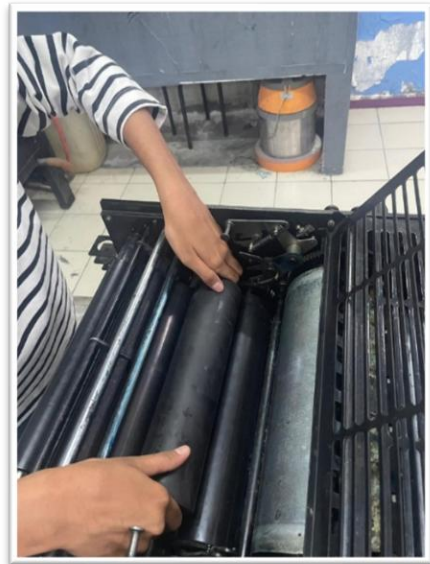
Gambar 12. Pemasangan Rol Tinta
