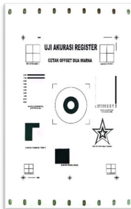
Gambar 4. Pelat Cetak Kertas Warna Hitam Suber: Dokumentasi Penulis
