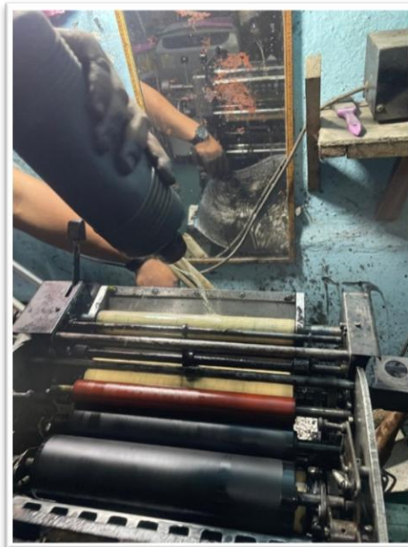
Gambar 19. Pembersihan Mesin Sebelum Pergantian Warna
