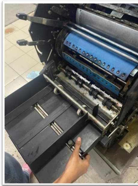
Gambar 18. Pengaturan Tempat Pemasukan Kertas
