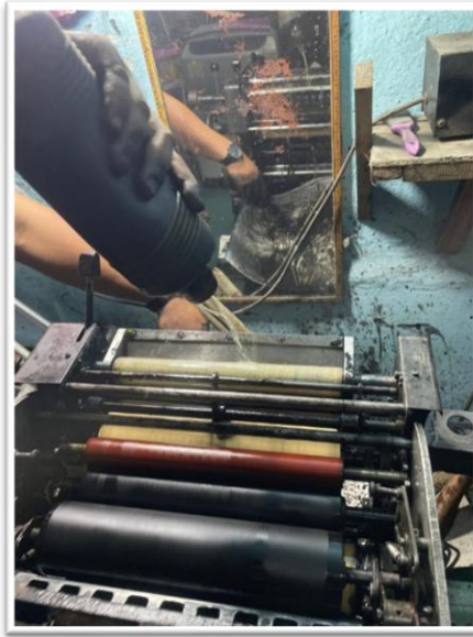
Gambar 11. Pembersihan Mesin Offset Toko 820
