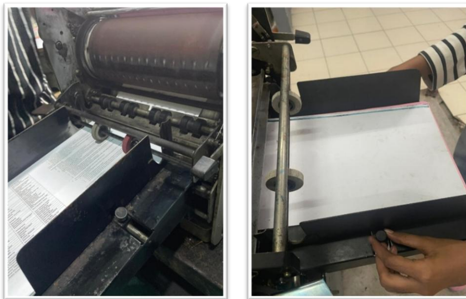
Gambar 20. Pengaturan Register Arah Kiri dan Kanan
